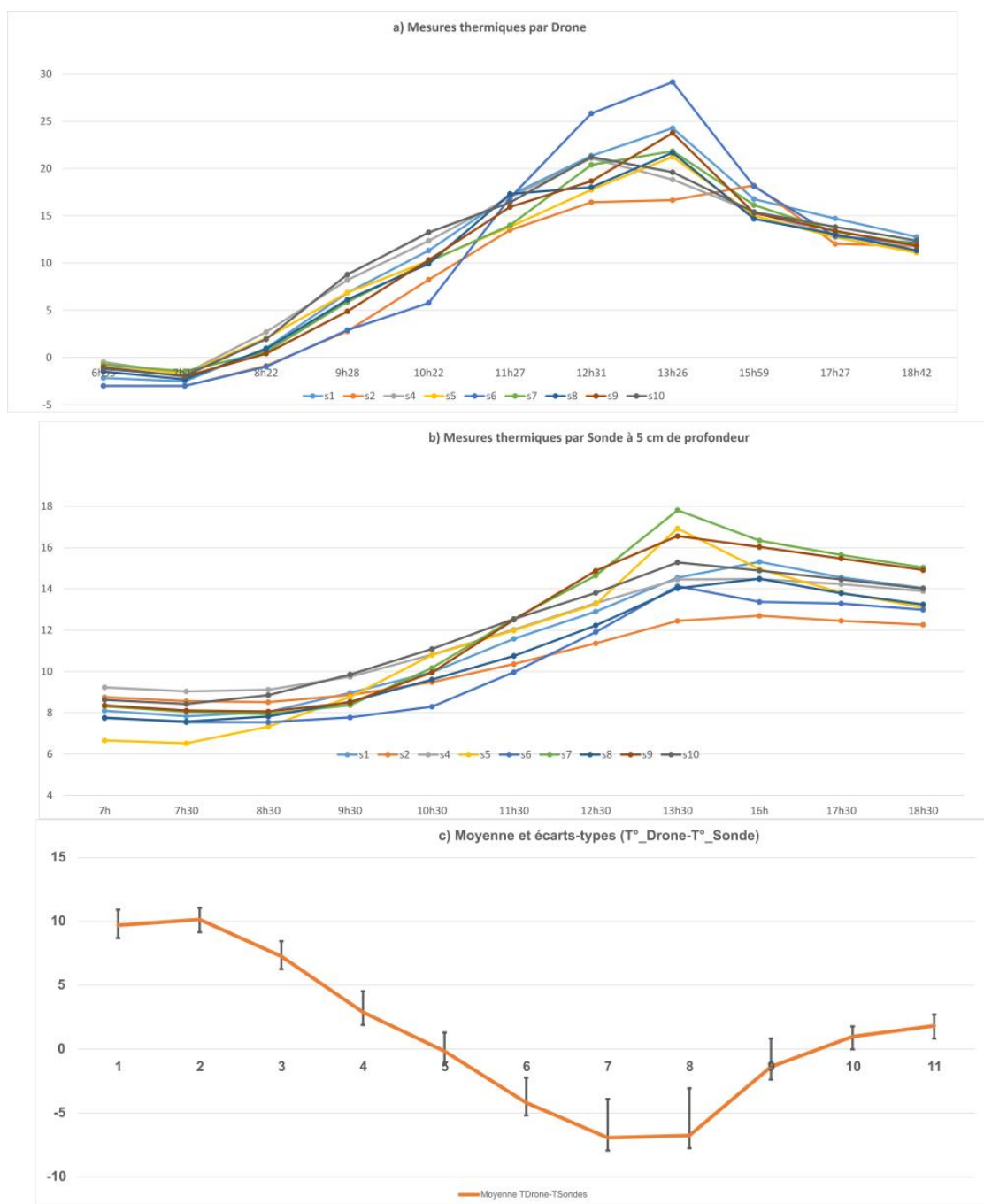
Figure 11. a) Températures moyennes recueillies à +/- 30 cm des sondes au sein d'un polygone de 60 cm de côté contenant 16*16 pixels. b) Température des sondes ponctuelles recueillies au premier capteur à 5 cm de profondeur. c) Moyenne et écarts-types des différences entre la température de surface relevée par drone et la température à 5 cm de profondeur relevée par sonde ponctuelle, présentées dans les figures a) et b) pour chacune des 11 heures de vol en drone.
