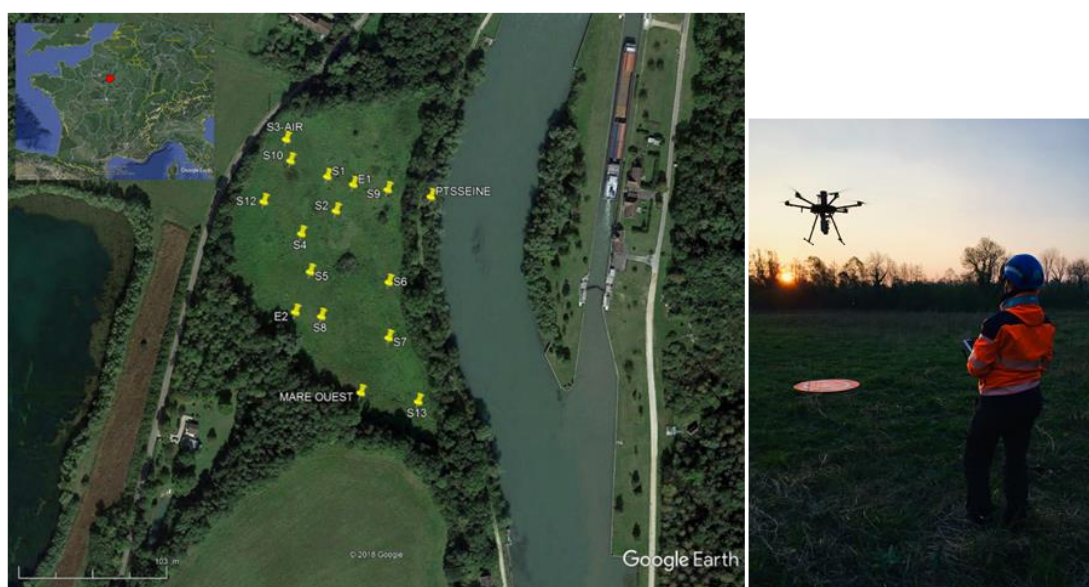
Figure 1. Plan de position des dispositifs de calibration multi-profondeurs de température et des sondages électriques (S1, S2, S3, S4, S5, S6, S7, S8, S9, S10, S12), des forages à la tarière (S1, S2, S5, MARE OUEST) et de la mesure de la température de la Seine (PTSEINE) ; E1 et E2 indiquent respectivement le début et la fin de la tomographie résistivité électrique de référence. À droite, photo du drone durant l'acquisition.
