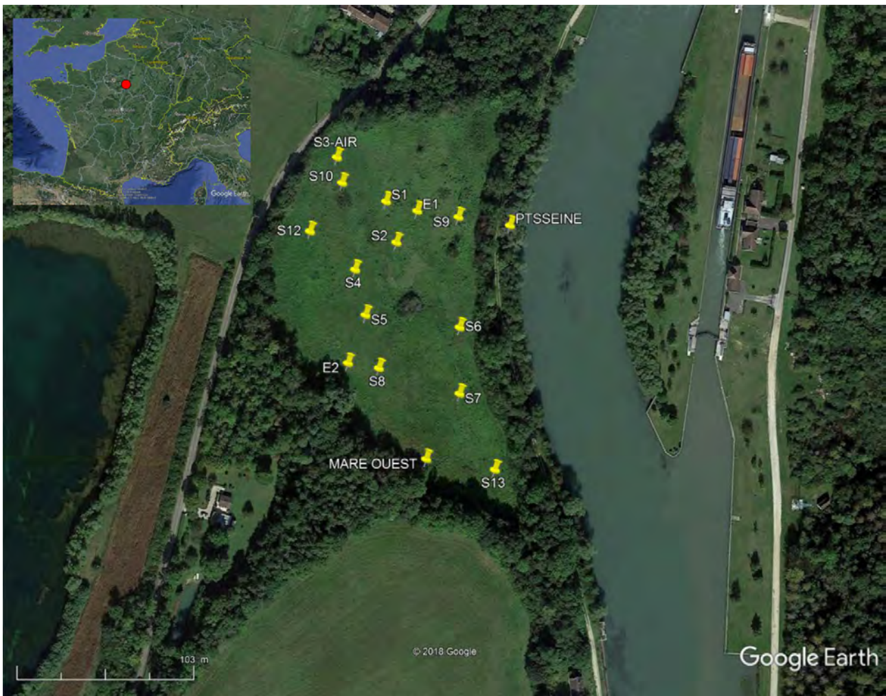
FIGURE 10.1. Plan de position des dispositifs de calibration multi-profondeurs de température et des sondages électriques (S1, S2, S3, S4, S5, S6, S7, S8, S9, S10, S12), des forages à la tarière (S1, S2, S5, MARE OUEST) et de la mesure de la température de la Seine (PTSEINE); E1 et E2 indique respectivement le début et la fin de la tomographie résistivité électrique de référence.
