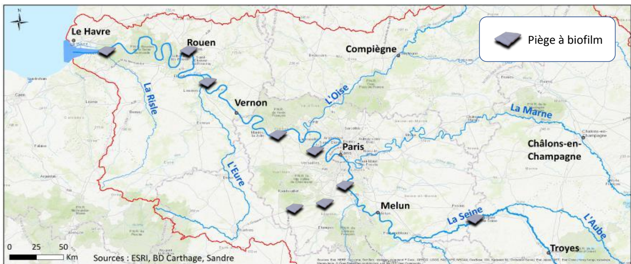
Figure 1. Positionnement des pièges à biofilms le long de l'axe Seine et de l'un de ses affluents (Orge). Conception et instrumentation des sites par l'UMR M2C.
