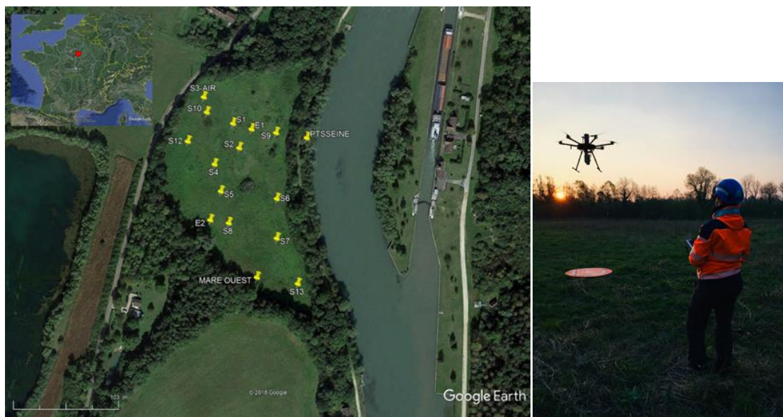
Figure 1. Plan de position des dispositifs de calibration multi-profondeurs de température et des sondages électriques (S1, S2, S3, S4, S5, S6, S7, S8, S9, S10, S12), des forages à la tarière (S1, S2, S5, MARE OUEST) et de la mesure de la température de la Seine (PTSEINE); E1 et E2 indique respectivement le début et la fin de la tomographie résistivité électrique de références. A gauche, photo du drone durant l'acquisition.
