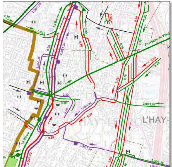
Figure 3 : Réseaux unitaire (violet), pluvial (vert) et d’eaux usées (rouge) en parallèle.(DSEA94, 2013)
