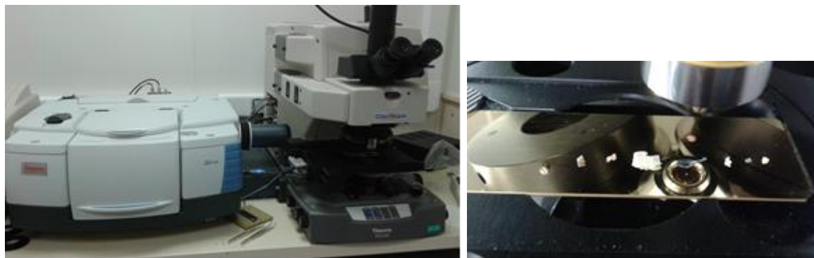
Figure 8 : Micro-spectroscopie IRTF-RTA et lame d'observation
