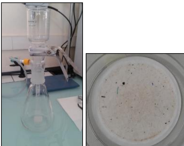
Figure 6 : Unité de filtration et filtre.
