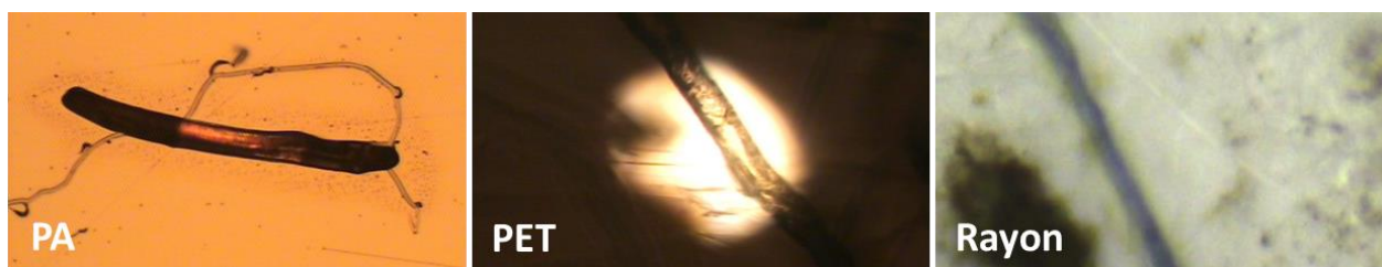
Figure 15 : Exemples de fibres identifiées à l'aide de la micro-spectroscopie IRTF.
