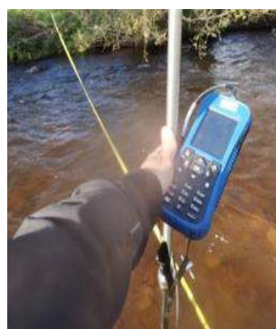
Mesures directes de débits (couranto, ADCP)
