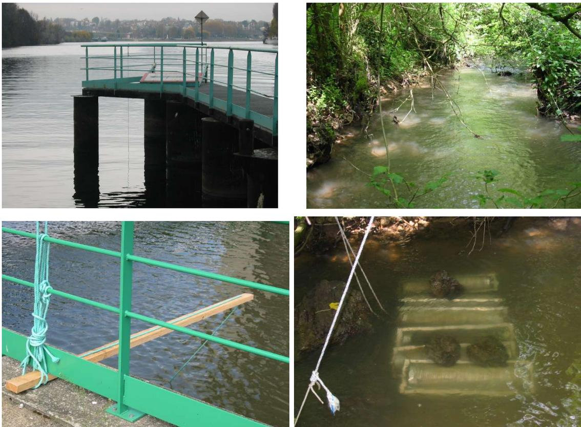
Figure 11 : Exemples de positionnement de SPMD. A Andrésy, à gauche, à la point de l'écluse (vitesse lente) ou à l'amont du barrage (vitesse rapide). Au Theil, à droite, vue du site en haut, et vue des SPMD en place en bas
