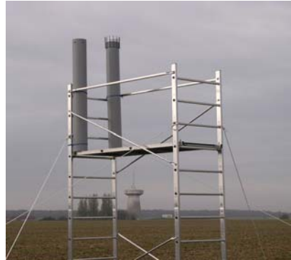
Figure 1: vue du dispositif de collecte de retombées atmosphériques.
