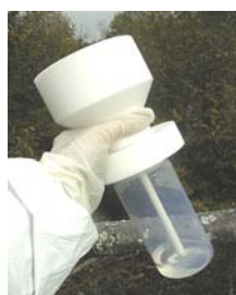
Figure 2 : préleveur de retombées totales
