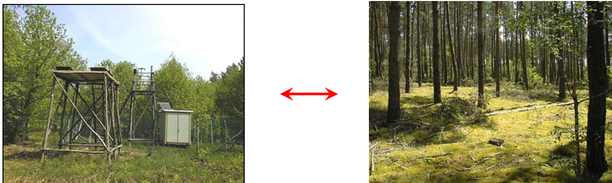
Figure 6 : dispositif d'étude de la fonction de transfert atmosphère mousses sur le site de Vouzon comprenant la placette de mesure du dépôt atmosphérique(10x10 m) et la placette mousse adjacente(100x100 m).
