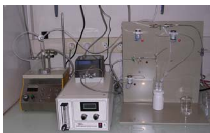
Figure 3 : Analyseur de mercure.
