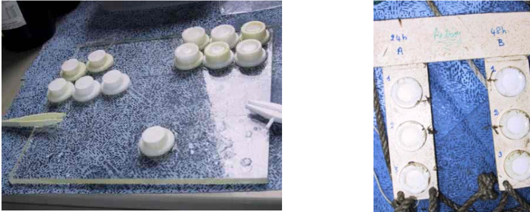
Figure 1. Mise en place au laboratoire sur un support DGT en plastique des différents gels chélantant et diffusif (gauche) ; Six DGT après déploiement à Andrésy pendant trois jours (droite).
