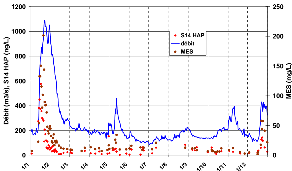
Figure 3 – Variations temporelles du débit de la Seine à Paris (Austerlitz) et des concentrations en MES totales et HAP totaux ( \Sigma 14 \text{ HAP} ) mesurées en Seine à l'amont de l'île de la Cité pendant la période du 1 er janvier au 31 décembre 2004
