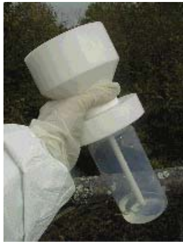
Figure 1 : préleveur métaux traces et mercure
