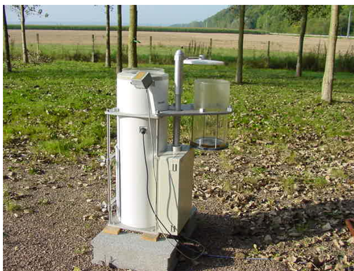
Figure 1 - Collecteur de retombées sèches et humides
