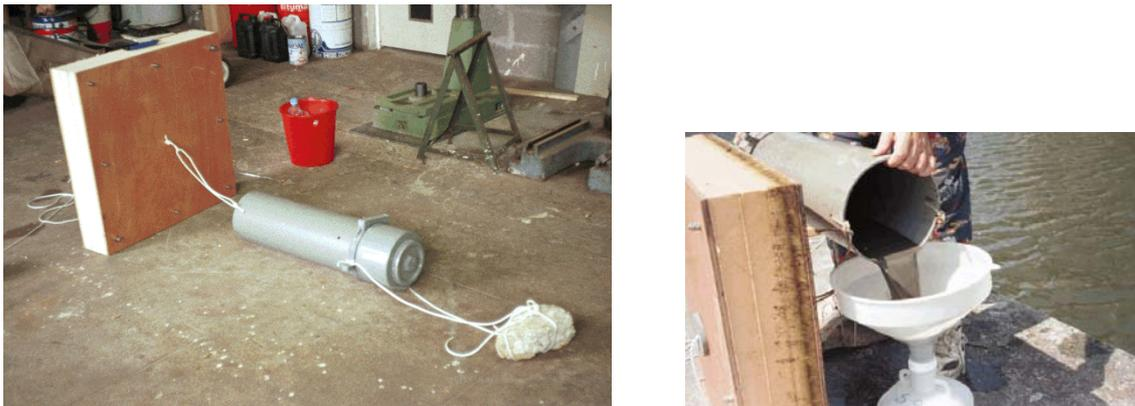
**Figure 1 :** Piège à sédiment et récupération d'un échantillon
