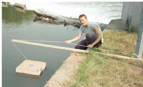
**Figure 2 :** Piège à sédiment en place au barrage de Denouval
