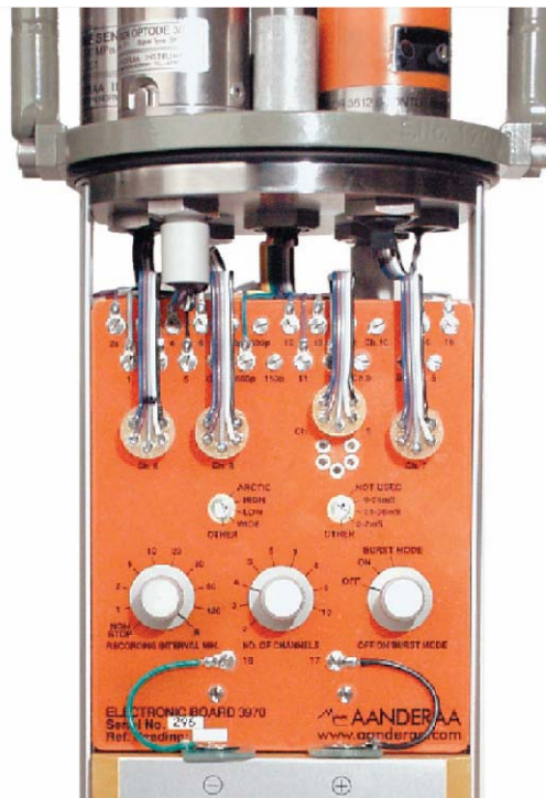
Figure 5 : Le datalogger Aanderaa et l'électronique de mesure du RCM9
