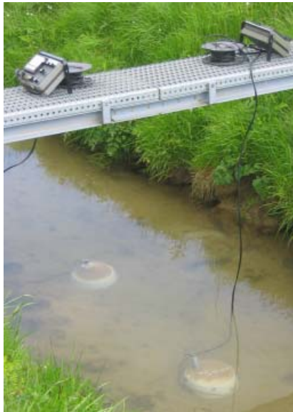
Photographie 1 : Cloches benthiques utilisées lors de lacampagne de prélèvements à Melarchez en Avril 2005
