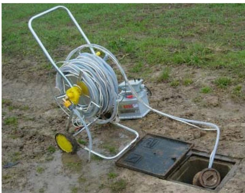
Figure 3 : Photo du prélèvement en piézomètre
