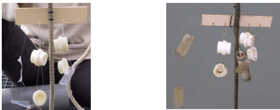
Figure 10. Photographies des dispositifs DGT et SPMD, avant et après déploiement d'une semaine dans la Seine.
