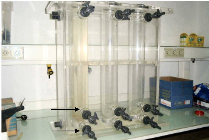
Figure 5.2. Colonnes de sédimentation. Le robinet supérieur indiqué par une flèche permet de récupérer à l'issue de l'expérience la phase en suspension et le robinet inférieur indiqué par une flèche permet de récupérer à l'issue de l'expérience la fraction décantée.
