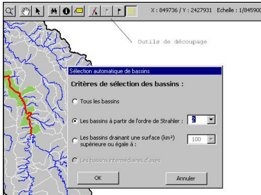
Figure 6 : Boîte de paramétrage pour la sélection automatique de bassins
