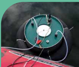
Chambre flottante sur la gravière de la Cocharde, pour la mesure des flux de CO 2 et CH 4 à l'interface eau-atmosphère.
