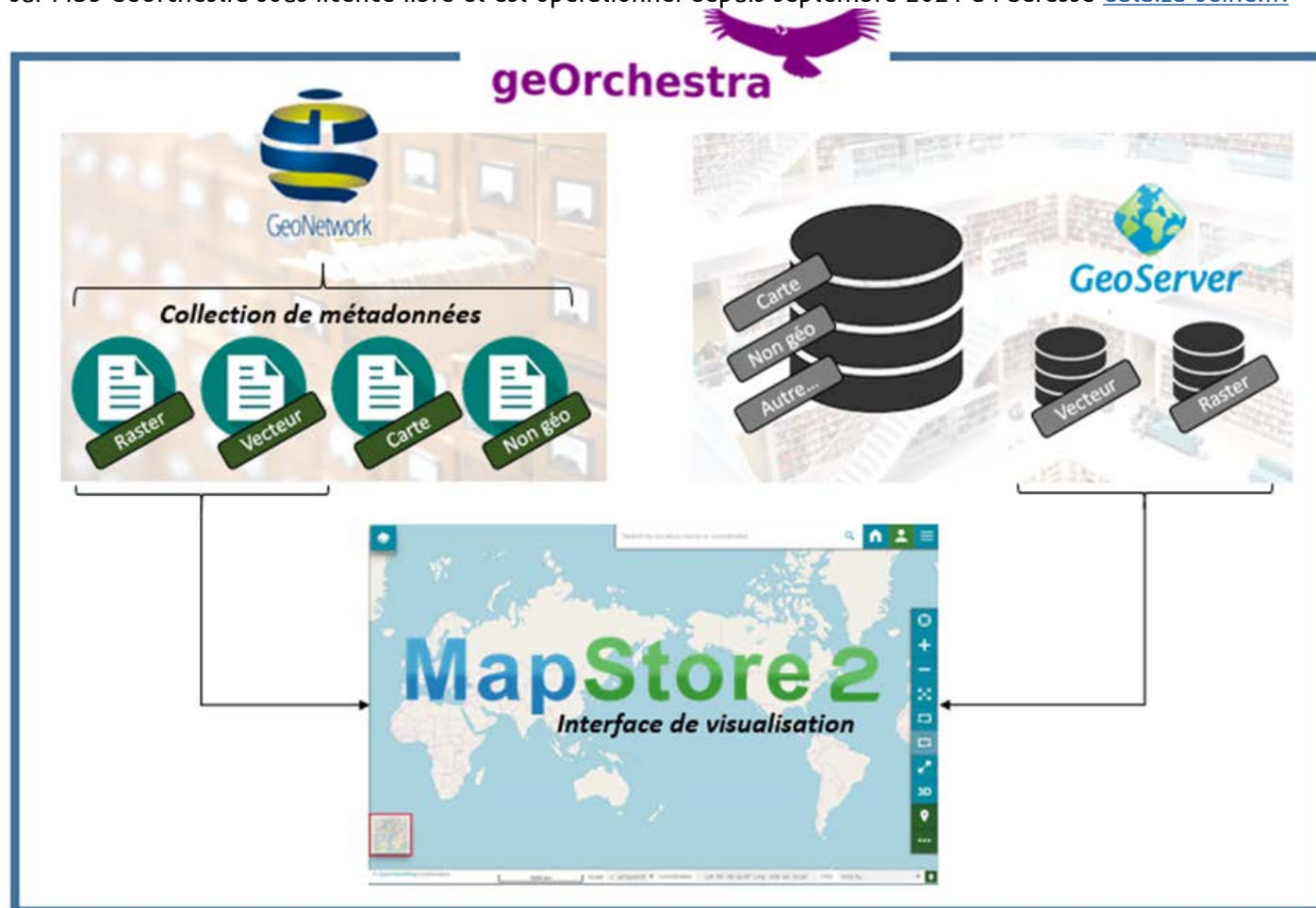
Figure 6 – Présentation schématique de l'outil retenu par le PIREN-Seine et la ZA Seine. L'IDS se compose d'un géocatalogue (GeoNetwork), d'un serveur permettant de gérer les données spatiales (GeoServer) et d'un visualiseur (MapStore2). L'ensemble est mis en musique par GeoOrchestra.
